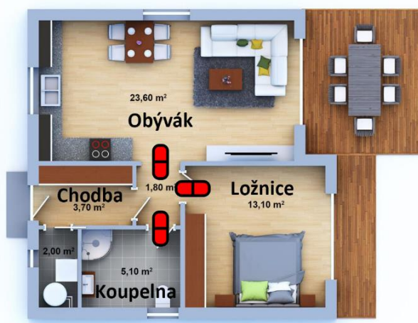
Obr. 8.1 Půdorys domu se se zakreslenými detektory průchodu [45]
