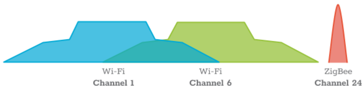
Obr. 4.6 Rozdělení komunikačních kanálů pro různé technologie na 2.4 GHz [23]
